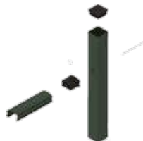
Connexion au poteau intermédiaire.
