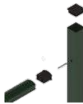
Connexion au poteau d'extrémité.
